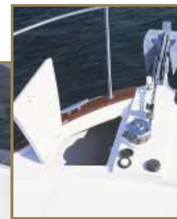
Puits à chaîne - guindeau électrique Anchor well - electric windlass
